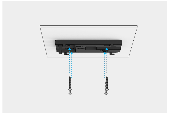
Deckenmontage, Option 2: Kabelausgang entlang der Oberfläche
