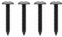
Fixation murale Vis (4 pièces) Longueur : 30mm Diamètre : 5mm Empreinte : cruciforme Phillips n° 2
