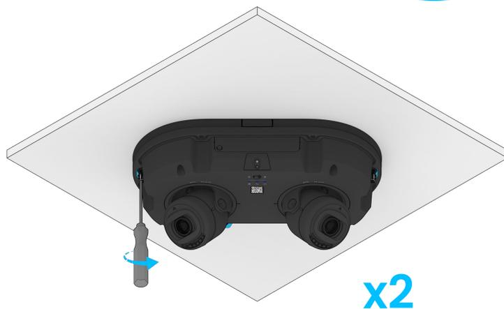
Ouvrez la fixation et passez le câble au travers.
