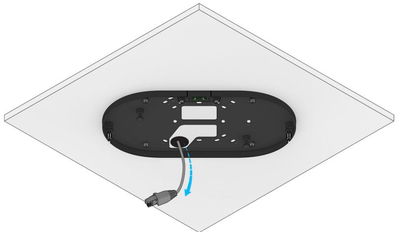
Pase el cable Ethernet a través de la abertura de la placa de montaje.
