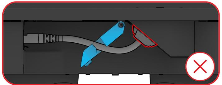
Asegúrese de que el pestillo esté completamente bajado y cerrado antes de apretar el tornillo de seguridad.
