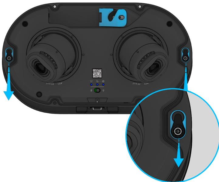
Apriete los tornillos con el destornillador de seguridad T10 para fijarlos.
