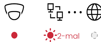
Beispiel für 2-Mal Rot blinkende LAN-Fehler-LED
