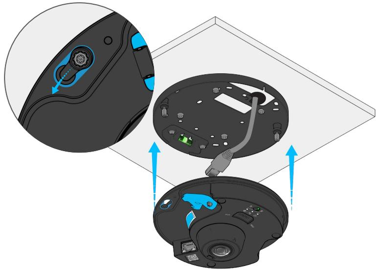
T10セキュリティドライバを使用してつまみネジを締め、固定します。
