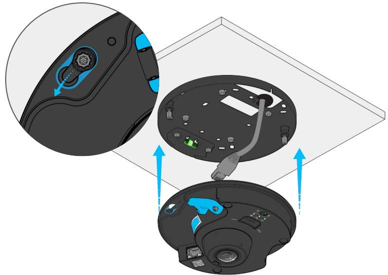
Zur Sicherung ziehen Sie die Rändelschrauben mit dem T10-Sicherheitsschraubendreher fest.
